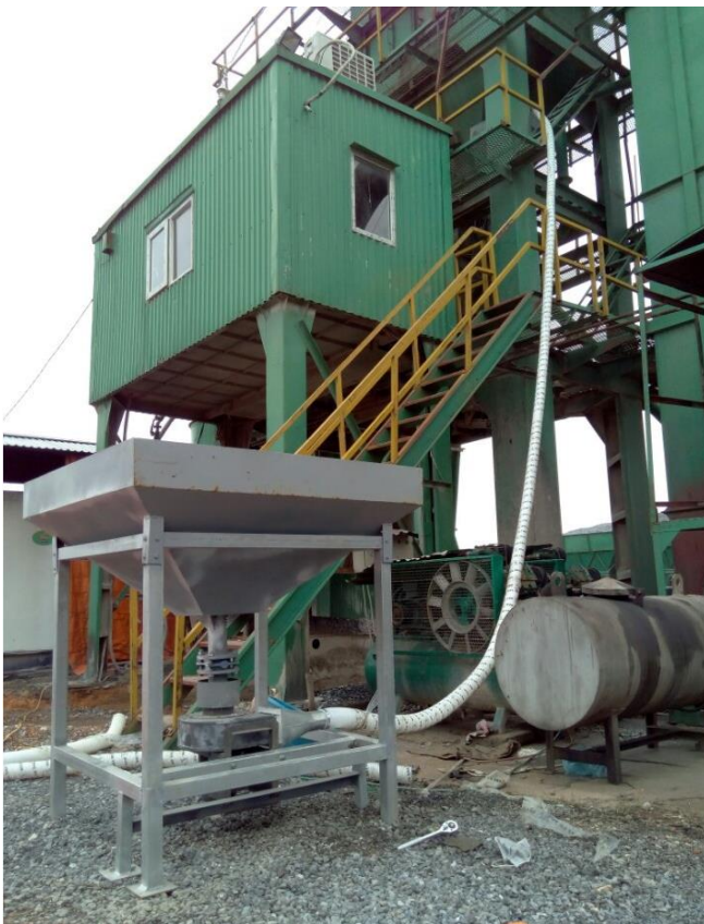
Hình 2: Ví dụ minh họa thiết bị cấp phụ gia TPP định lượng tự động kết nối trực tiếp với trạm trộn, hoạt động đồng bộ với trạm trộn về thời điểm cấp phụ gia, thời gian cấp.
