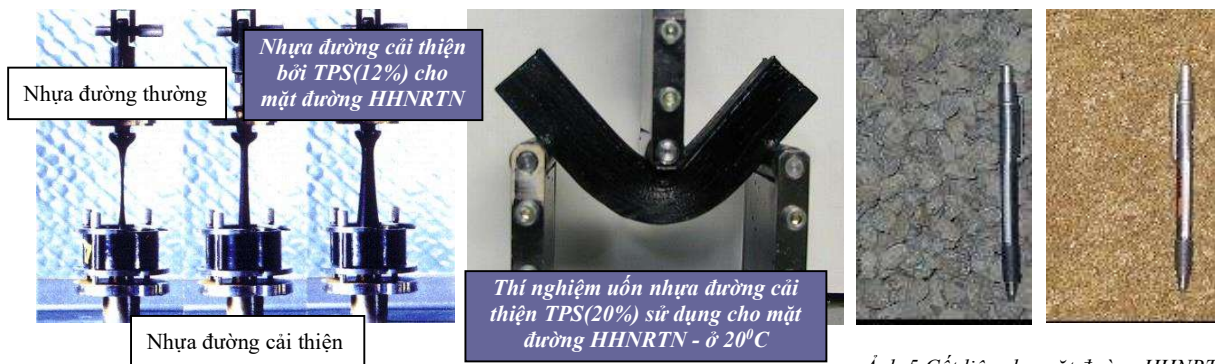
Ảnh-4 Nhựa đường cho mặt đường HHNRTN (Trái: thí nghiệm dai/Bền - Phải: Thí nghiệm uốn)
