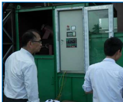
Ảnh-6 Hệ thống cân và cấp phụ gia tự động – đồng bộ với các mẻ trộn Bê tông nhựa
