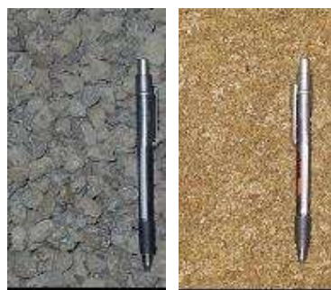
Ảnh-5 Cốt liệu cho mặt đường HHNRTN (Trái: Cốt liệu thô - Phải: Cốt liệu mịn)
