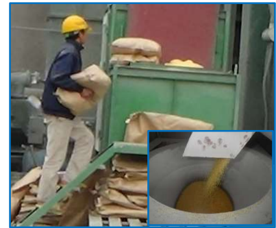
Ảnh-6 Hệ thống cân và cấp phụ gia tự động – đồng bộ với các mẻ trộn Bê tông nhựa
